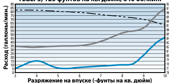
Зависимость расхода и шума от разрежения на впуске TLGLF3, 125 фунтов на кв. дюйм, 640 об/мин.
